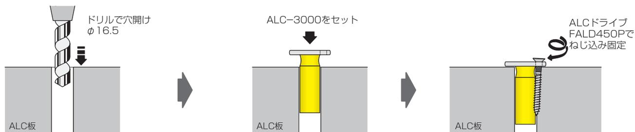
※全ネジボルト固定時の強いトルクでの締め込みはしないで下さい。
